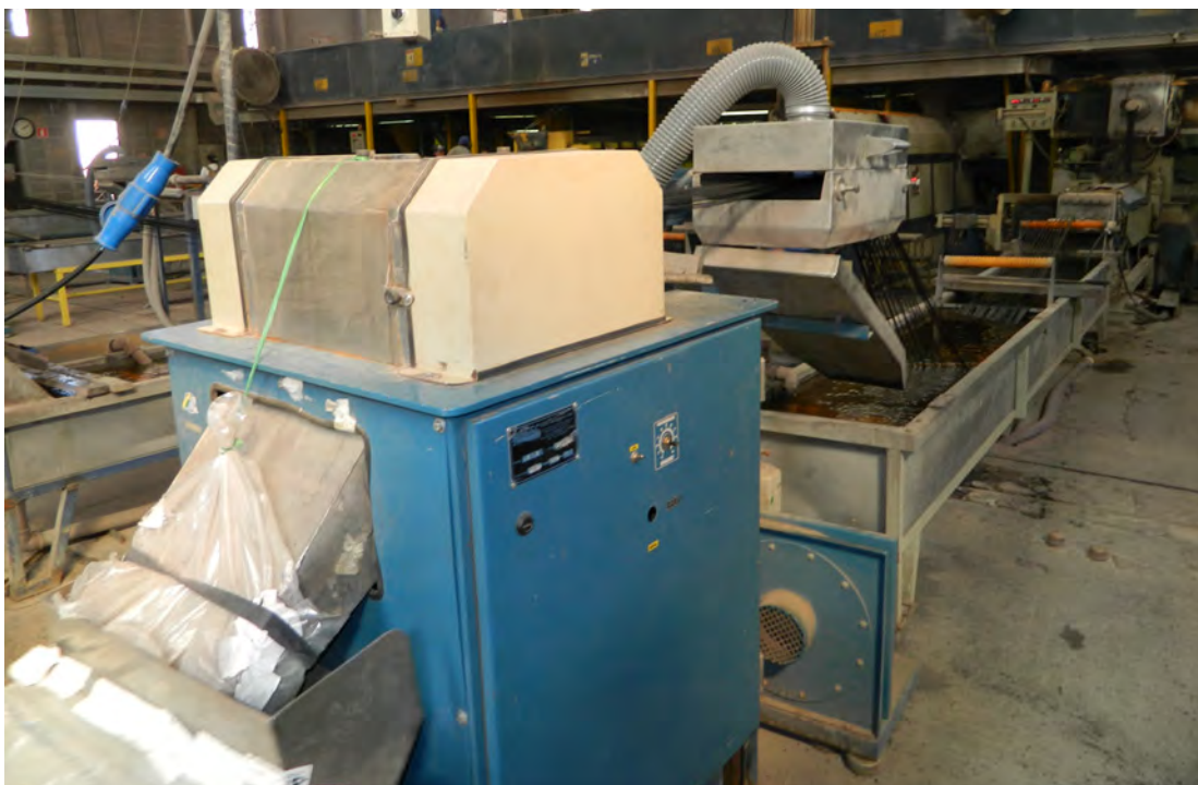
Figura 34 - Granulação com rotor de contra-facas
