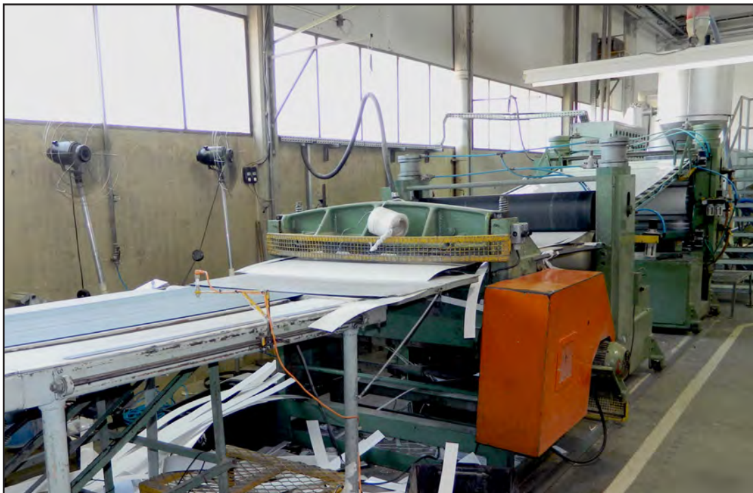
Figura 7 - Extrusora de chapas plásticas
